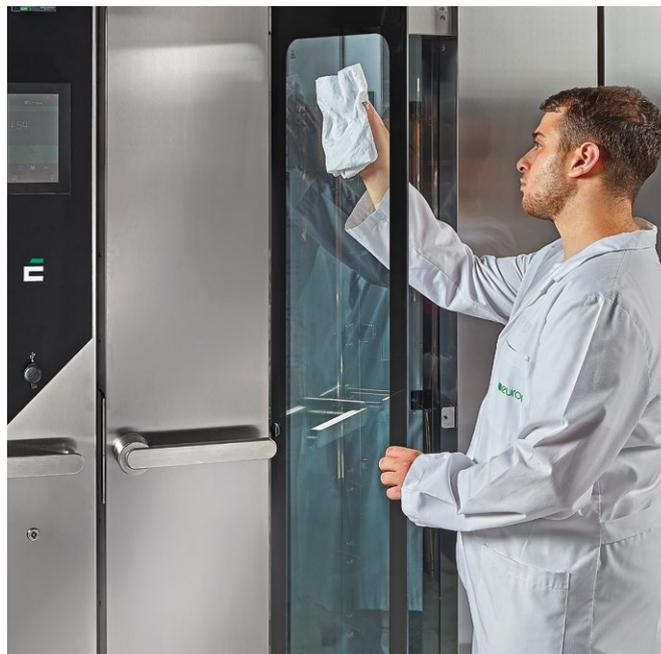
**Dettagli costruttivi igienicamente efficaci** grazie all'apertura a libro del vetro esterno della porta per una facile pulizia del vano tra i vetri e ad un pavimento privo di impedimenti che permette una pulizia estremamente efficace.
